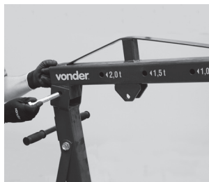
Figura 11 – Fijación del brazo en la torre y en el sistema hidráulico
