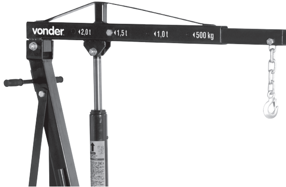
Figura 14 – Ajuste del prolongador y capacidad de carga
