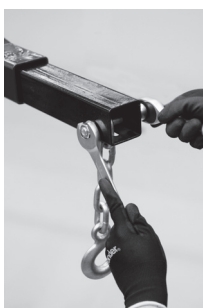
Figura 13 – Fijación de la cadena y gancho en el brazo del grúa
