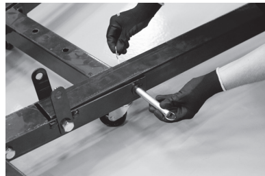
Figura 6 – Conectando los pies en la base del guinche
