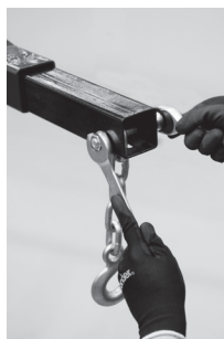
Figura 9 – Fixação da corrente e gancho no braço do guincho
