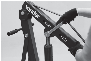
Figura 11 – Fijación del brazo en la torre y en el sistema hidráulico
