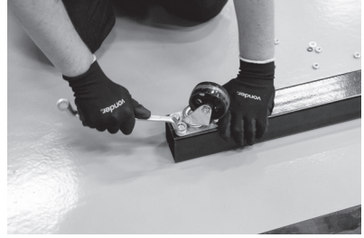
Figura 5 – Montaje de las ruedas en los pies del guinche
