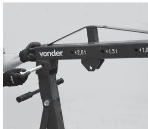
Figura 7 – Fixação do braço na torre e no sistema hidráulico
