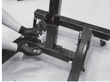
Figura 8 – Fijación de la torre en la estructura inferior del guinche montado
