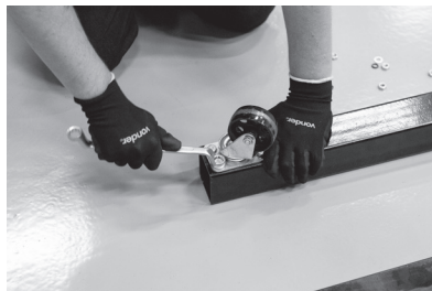
Figura 1 – Montagem dos rodízios nos pés do guincho
