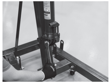
Figura 2 – Fixação do sistema hidráulico no suporte da torre
