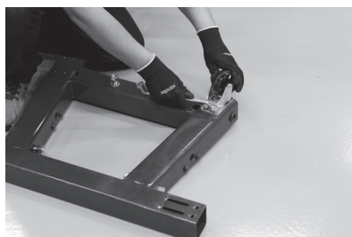
Figura 2 – Montagem dos rodízios na base do guincho
