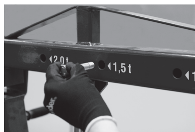
Figura 11 – Fijación del brazo en la torre y en el sistema hidráulico
