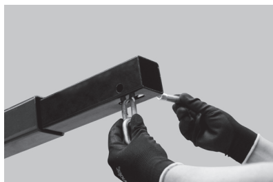
Figura 9 – Fixação da corrente e gancho no braço do guincho
