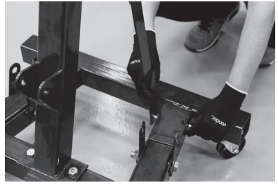
Figura 6 – Fixação das barras de sustentação nas laterais
