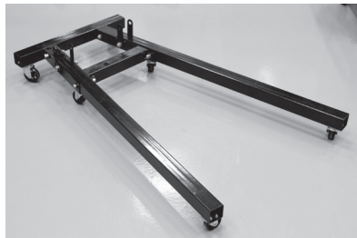
Figura 7 – Estructura inferior del guinche montado
