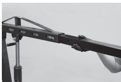
Figura 11 – Fijación del brazo en la torre y en el sistema hidráulico
