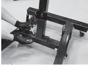
Figura 5 – Fixação da torre na estrutura inferior do guincho montado
