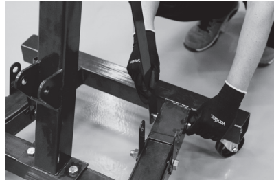
Figura 9 – Fijación de las barras de sustentación en las laterales
