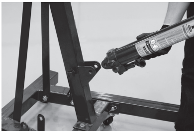
Figura 10 – Fijación del sistema hidráulico en el soporte de la torre
