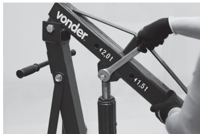
Figura 7 – Fixação do braço na torre e no sistema hidráulico
