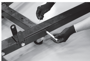
Figura 3 – Conectando os pés na base do guincho
