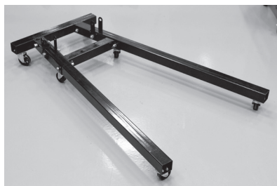
Figura 3 – Conectando os pés na base do guincho
